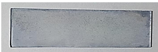
Hình 3.28: Ảnh chụp điện cực sau khi phủ xúc tác Pt/rGO/TNTs
