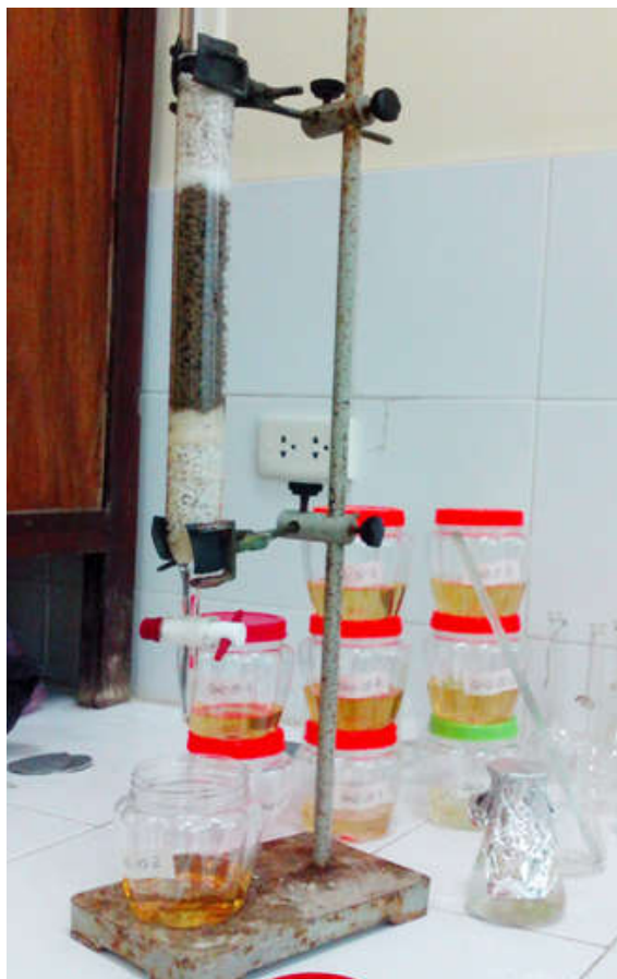
Hình 2.2: Thí nghiệm chiết rửa đất ô nhiễm
