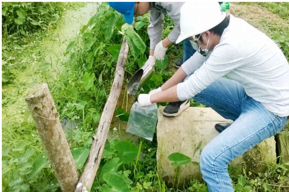
Lấy mẫu đất để so sánh (tại cửa ra cống của mương thoát nước)
