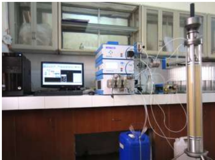
Hình 2. 2: Hệ thống Pilot Prep. HPLC và cột tách Sephadex ID 100 x L 800 mm
