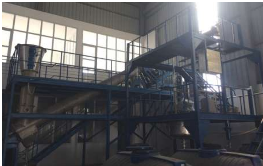
Hình 2. 8: Hệ thống chiết lỏng/rắn ngược dòng liên tục
