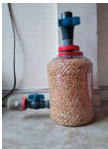
Hình 2.10. Vi môi trường bảo quản ngô bằng phương pháp xông hơi khử trùng
