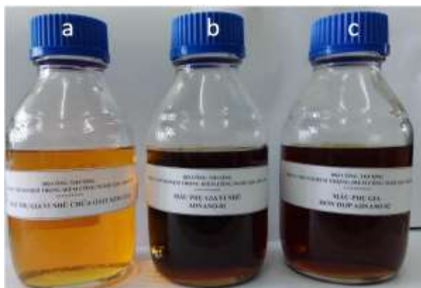
Hình 3.8. Hình ảnh các mẫu phụ gia hợp phần: Phụ gia vi nhũ chứa oxide sắt (a), phụ gia vi nhũ nước trong dầu (b) và phụ gia vi nhũ thể hệ mới (c)
